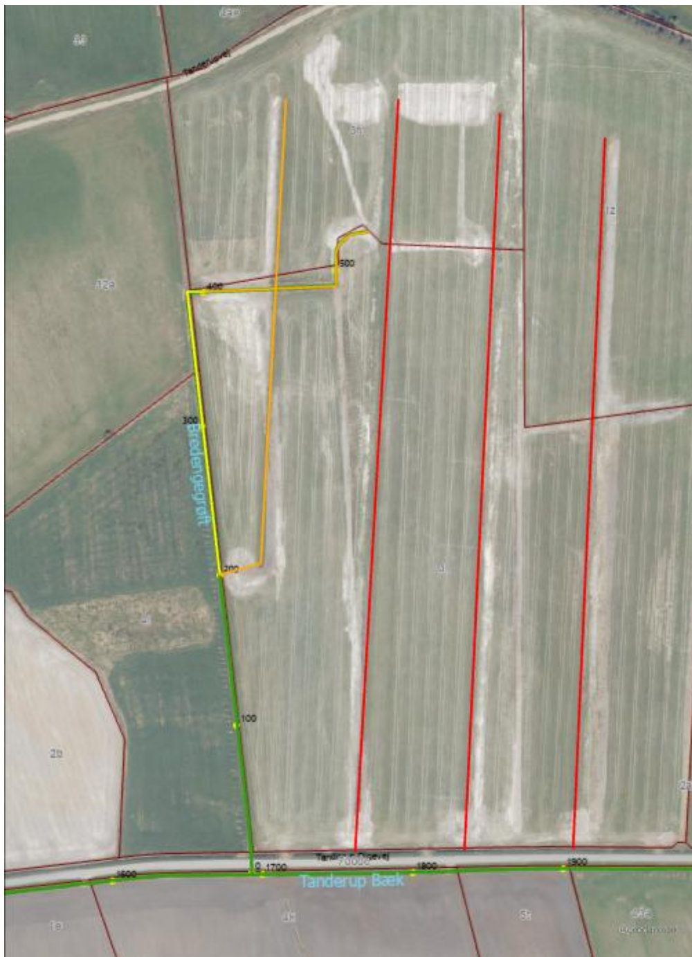
Figur 2. Oversigtskort over Bredengegrøft. De offentlige vandløb er markeret med grøn. De røde linjer er de tre nye grøfter der er etableret. De orange streger er den forlægning af Bredengegrøft der er udført, mens den gule streg er markerer sløjfningen som ikke er udført endnu.
