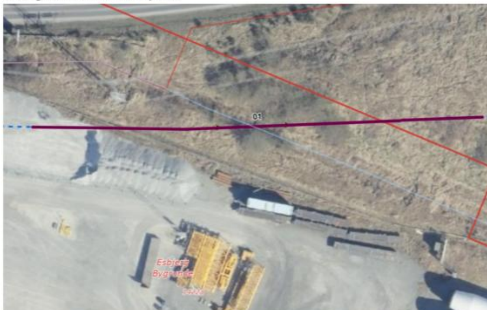
Figur 1 Matrikel 1422a Esbjerg Bygrunde - vandløb krydses ved styret underboring.
