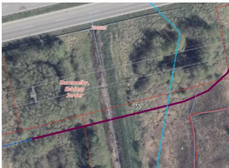
Figur 2 Matrikel 7000ax Gammelby, Esbjerg Jorder - vandløb og beskyttet vandløb krydses ved styret underboring.
